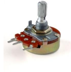
شكل رقم ٣١: المقاومة المتغيرة والدائرة المكافئة لها كمجزي للجهد.
